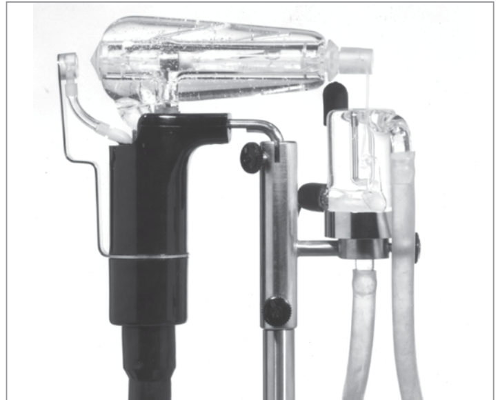
FIG. 9 MICROELETTRODO CAPILLARE PER IL PH DEL SANGUE
