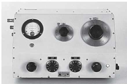
FIG. 7 UNO DEI PRIMI PH-METRI
